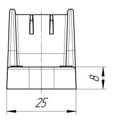
Углубление с ребрами для установки на ствол монтажного пистолета
