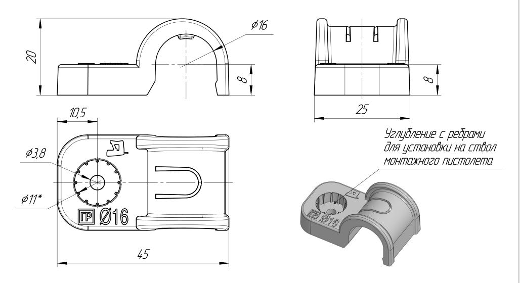
арт. PR13.0368 — Крепеж—скоба пластиковая односторонняя для прямого монтажа серая в п/э д16 Промрукав
